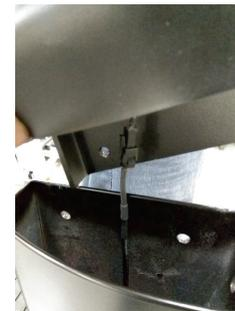
В верхней части правой стойки соедините провод BW с проводом CW. Прикрепите поручень (C) к деталям A и B с помощью 6 винтов (GG), используя прилагаемый шестигранный ключ диаметром 5 мм (JJ).
