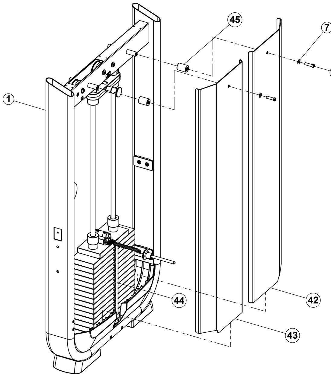
**ПРИМЕЧАНИЕ:** закрутите болты пальцами до упора, затем затяните ключом еще на 1/2 оборота
