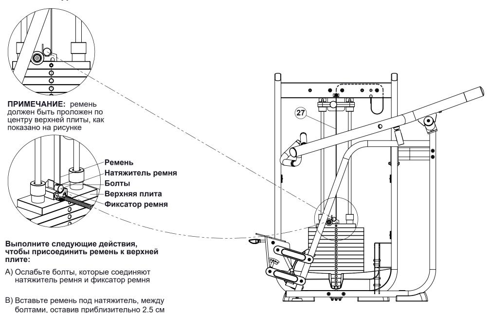
С) Плотно затяните болты, соединяющие натяжитель и фиксатор ремня
