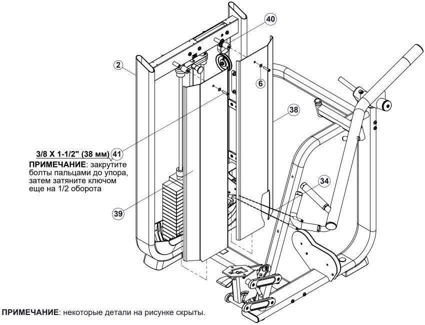
• ПРИМЕЧАНИЕ: проложите трос через отверстие правого защитного экрана пред тем, как установите защитный экран на стойку грузоблока.
